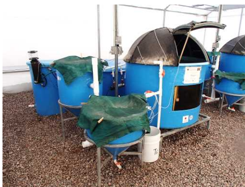
CIBNOR モデルシステムの閉鎖循環式 魚類飼育装置
